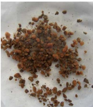
Figura 7. Fotografía tomada a la biomasa granular obtenida en el reactor airlift de eliminación autótrofa de nitrógeno.
